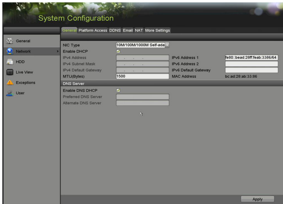
Figure 171 Interface des paramètres réseau
