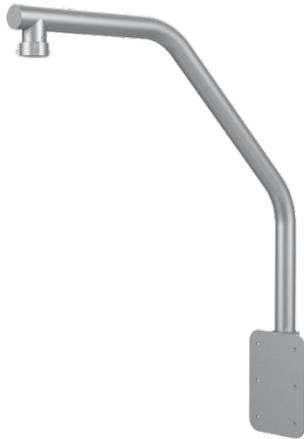
Le support doit être installé sur une surface plane. Le caoutchouc imperméable est nécessaire pour une application extérieure. Le mur doit pouvoir supporter au moins trois fois le poids total de la caméra et de la monture. La capacité de charge maximale du support est de 10 kg (22 lb).
