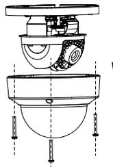
3. Installez le corps de la caméra à dôme dans l'ouverture du support, le fil et fixez avec la vis.
