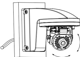
5. Remplacez le boîtier et serrez les vis.
