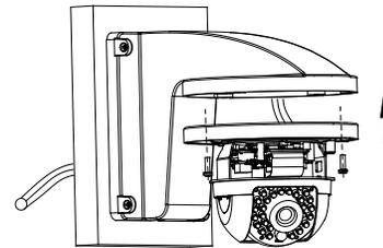
4. Ajustez l'angle à l'aide de la structure d'ajustement triaxiale.
