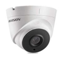
Les caméras tourelles extérieures DS-2CE56H1T-IT3 de Hikvision constituent une solution polyvalente pour tous vos besoins de sécurité. Elles disposent d'un angle de vision large qui capture des images avec une résolution de 5 Mpx jusqu'à 20 ips. La caméra tourelle prend en charge le protocole Hikvision Up-the-Coax, le WDR numérique, et est équipée d'une lampe infrarouge d'une portée allant jusqu'à 131 pi (40 m), ce qui facilite l'enregistrement nocturne.
